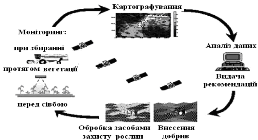
Рис.1 – Схема реалізації технологій точного землеробства
