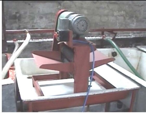
Рисунок 1 – Експериментальна установка з двовалковим робочим органом
