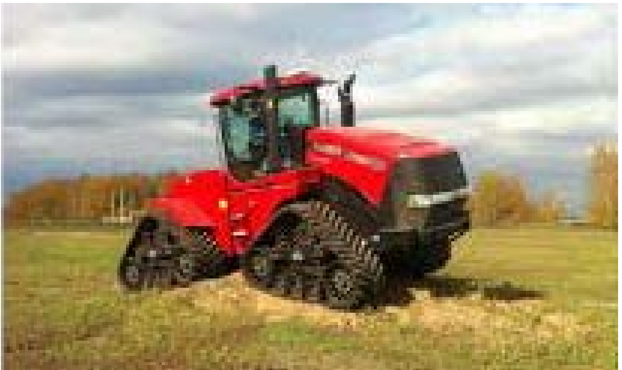
Рис. 12 Трактор Case Quadtrack з шарнірно-зчленованою рамою, яка ламається
