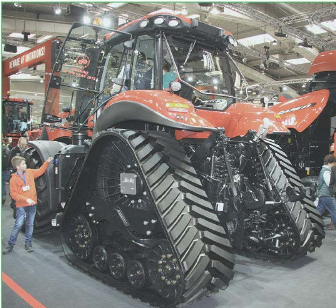
Рис. 11 Трактор Magnum 380 CVX від CASE IH на гусеничному гумоармованому ході
