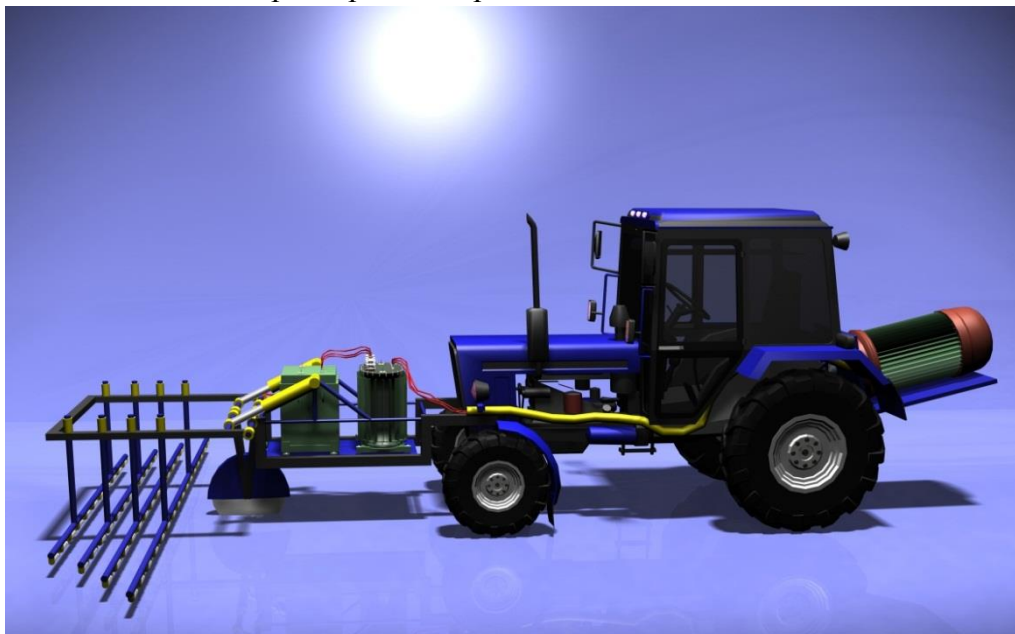
Рис. 1. Электроимпульсный пропольщик, навешиваемый на колёсный трактор
