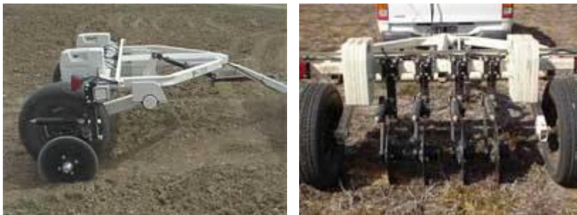
Рис.4 - Система реєстрації електропровідних властивостей ґрунту Veris
