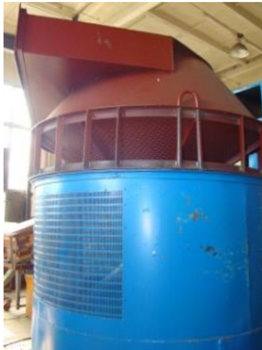
Рис. 5.17. Загальний вигляд стенду вдосконаленої пневмоканальної системи до установки для дослідження пневмовідцентрового процесу сепарування
