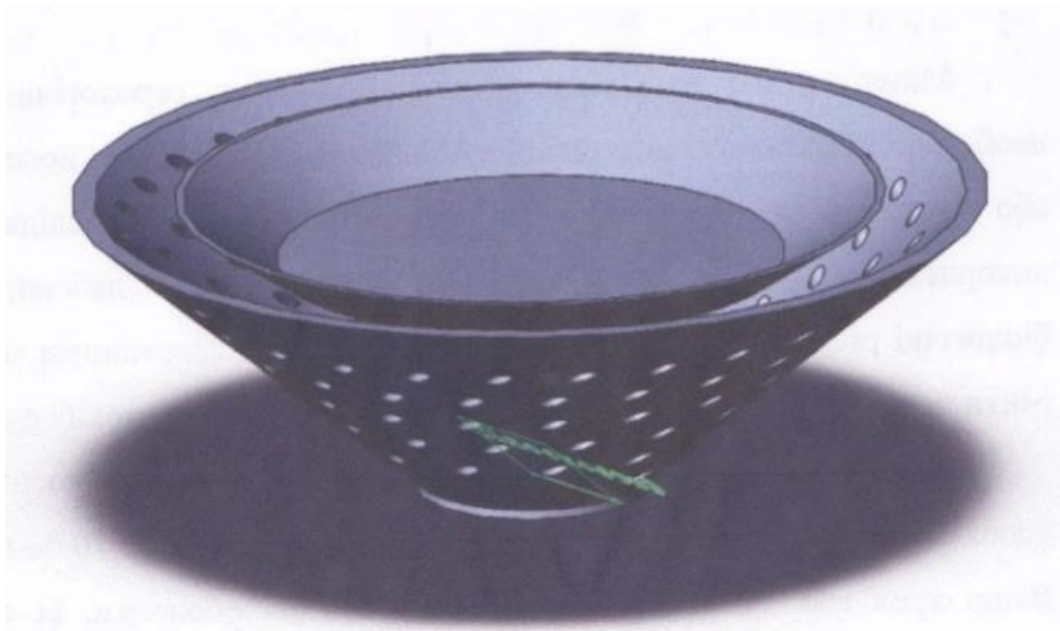
Рис. 7.9. Схема перфорованого конуса з обертальним робочим органом (диском) для реалізації моделювання швидкостей руху пневмовихрового середовища
