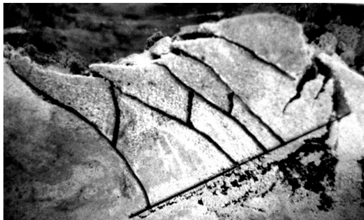
Рисунок 3. Характерное трещинообразование при работе лемеха (С целью повышения контрастности трещины наведены фломастером)
