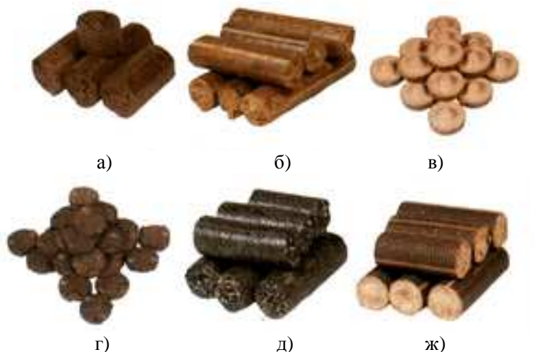
Рис. 1. Зразки паливних гранул в залежності від виду вихідної сировини: а – лушпиння гречки, б – солома зернових культур, в – деревна стружка, г – торф, д – лушпиння соняшника, ж – лушпиння рису
