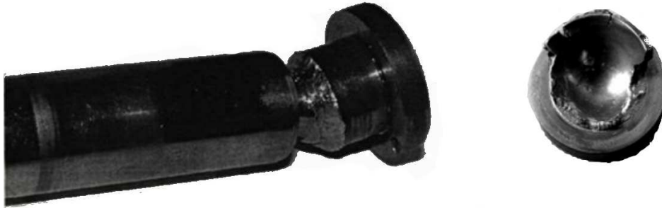
Рис. 2. Вигляд можливого спрацювання поршня та під'ятника
