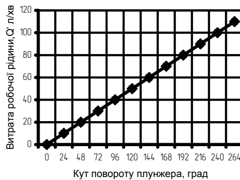
Рис. 2. Тарувальна характеристика витратоміра постійного перепаду тиску.
