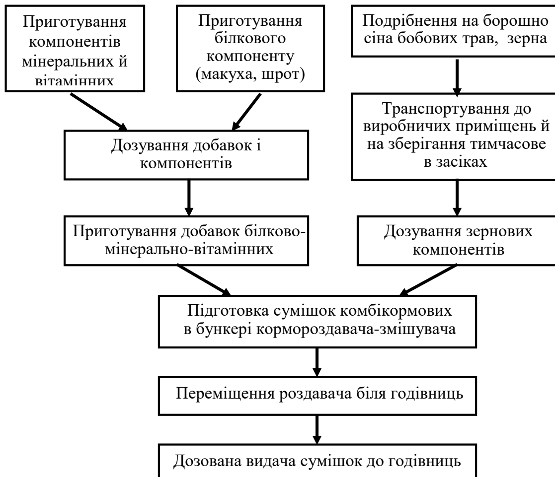
Рисунок 1 – Пропонована схема технологічного процесу щодо підготовки та видачі корму свинопоголів'ю за використання кормороздавача-змішувача
