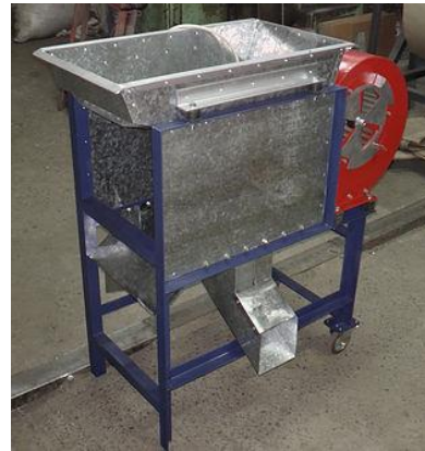
Рисунок 1. Аеродинамічний сепаратор для очищення ягід від легких домішок
