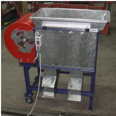
Рисунок 1. Аеродинамічний сепаратор для очищення ягід від легких домішок
