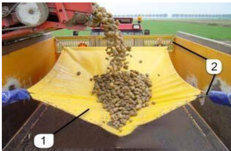
Рис. 1.4 - Зниження пошкоджуваності овочів за допомогою амортизувального полотна, змонтованого на кузові транспортного засобу на пружних підвісках: 1 - полотно; 2-підвіски пружні
