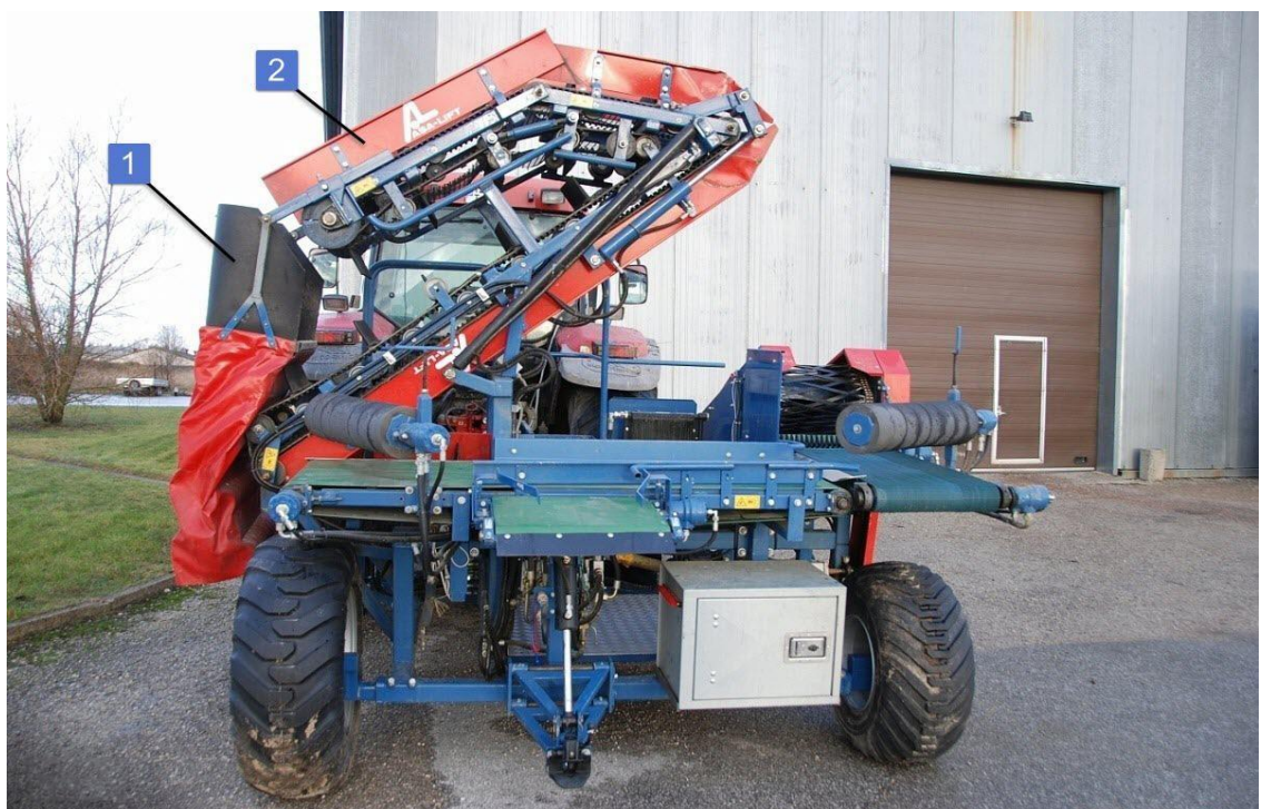
Рис. 1.17 - Капустозбиральна машина фірми Asa-lift із закритим відвантажувальним пристроєм: 1-закритий "хобот"; 2-елеватор
