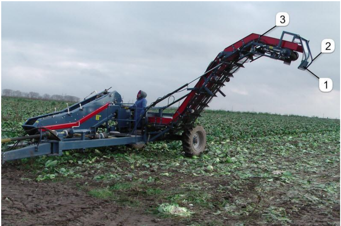
Рис. 1.16 - Капустозбиральний комбайн ККП - 1: 1 - щиток; 2 - рамка; 3 - елеватор
