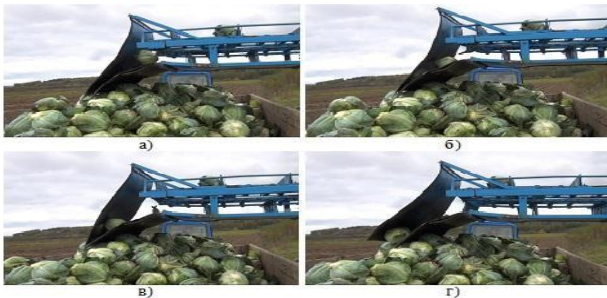
Рис. 3.23 - Покадрова фіксація процесу відвантаження качанів у кузов транспортного засобу: а - надходження качана на гнучкий пружний прогумований лоток; б - провалювання качана в клиноподібну щілину між лотком і фартухом; в - переміщення качана в щілині між лотком і фартухом; г - звільнення качана від відвантажувального пристрою
