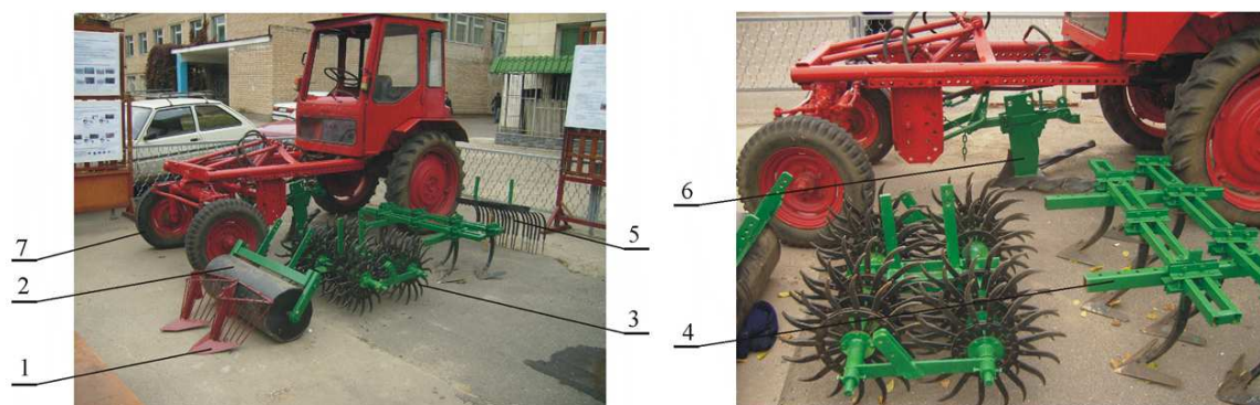
Рис. 6 - Навесное оборудование на агротехнологический модуль Универсал 1-20 для производства овощей и картофеля на капельном орошении: 1 картофелекопатель; 2 гладкий водоналивной каток; 3 борона игольчатая, дисковая; 4 универсальная рама в варианте “культиватор”; 5 борона зубовая; 6 глубокорыхлитель-плоскорез
