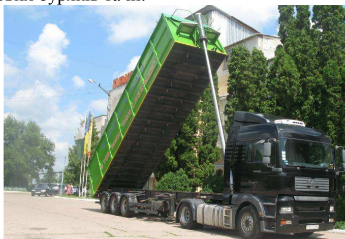
Рис. 7. Автомобільний напівпричіп-самоскид НПС 2150 (Україна) з автотягачем
