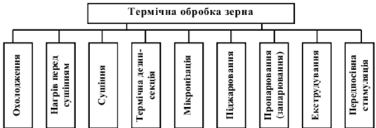
Рис. 3.1 - Види термічної обробки зерна
