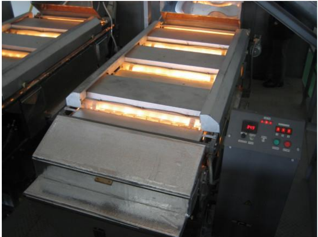
Рис.3.5 - Установка для термообработки зерновой сировини УТЗ–4 (виробник фірма «Старт»)
