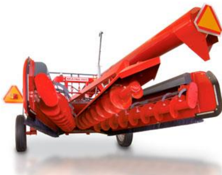
Рис. 2.5 - Фото машини для вивантаження зерна з полімерних рукавів «Екстрактора»
