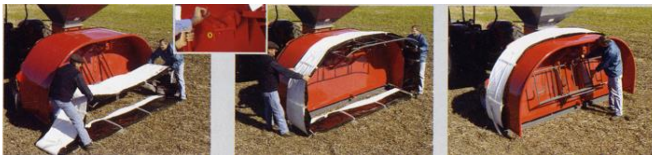
Рис. 2.3 - Фото машини для заповнення зерном полімерних рукавів «Беггера» фірми «Mainero»
