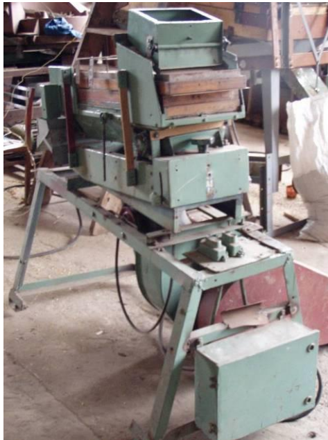
Рис. 4.13 - Конструктивна схема (а) і зовнішній вид (б) лабораторної вібраційно-пневматичної установки
