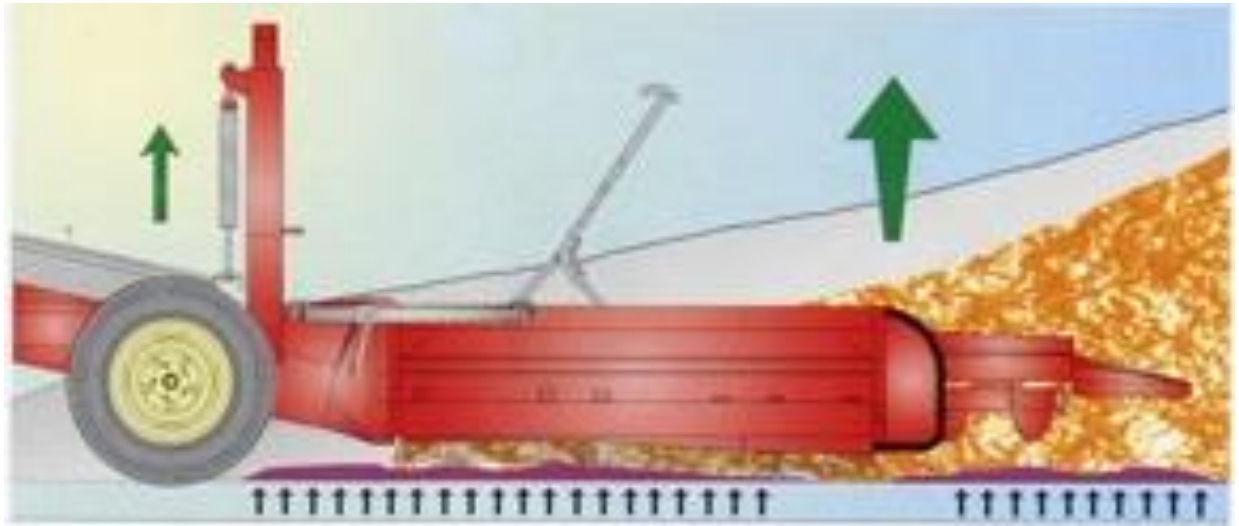
Рис. 2.6 - Схема роботи машини для вивантаження зерна з полімерного рукава «Екстрактора»
