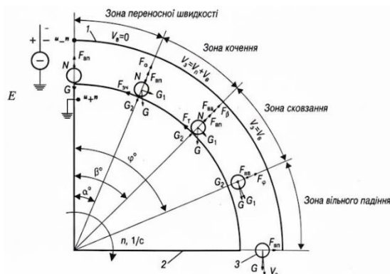
Рис. 2.3. Схематичний рух зернової частинки в різних кінематичних зонах електросепаратора по поверхні барабана: 1 - ізолюваний електрод; 2 - заземлений барабан-електрод; 3 - зернова частинка. N - сила реакції опори; F_{вц1}, F_{вц2} -
