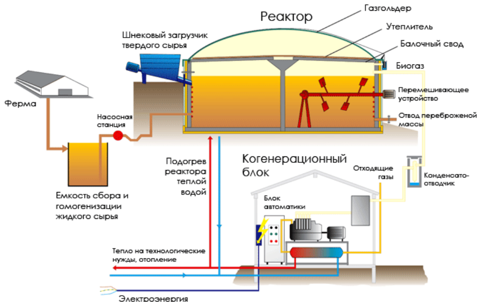
Рис. 2. Технологічна схема отримання біогазу від тваринницької ферми.
