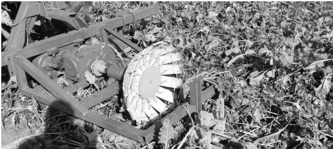
Рис. 1. Дослідний зразок нового копирно-роторного гичкозбирального робочого органу.
