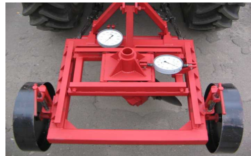
Рисунок 2 - Схема вимірювального візка для визначення складових тягового опору диска:
