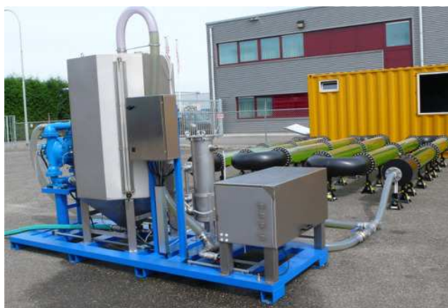
Рисунок 1 – Загальний вигляд установки для вирощування олійних водоростей на основі фітобіореакторів.
